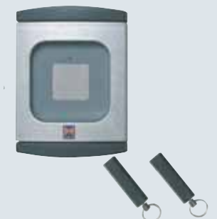
Transpondérový spínač TTR 100, TTR 1000 Komfortný spôsob otvárania brány: jednoducho podržíte transpondérový kľúč s Vaším osobným kódom cca. 2 cm pred čítacím prístrojom. Bez dotyku! Mimoriadne výhodné za tmy. Vhodné pre max. 100 transpondérových kľúčov (TTR 100) resp. 1000 transpondérových kľúčov (TTR 1000). Dodané budú dva transpondérové kľúče.
